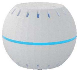
WiFi-датчик Shelly® H&T от компании Allterco Robotics предназначен для размещения в помещении/зоне, где необходимо получать информацию о влажности и температуре. Shelly H&T работает от элемента питания со сроком службы до 18 месяцев. Shelly может работать как отдельное устройство или как компонент домашнего контроллера автоматизации.
