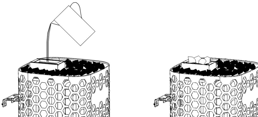
Заполнение водяного резервуара водой
