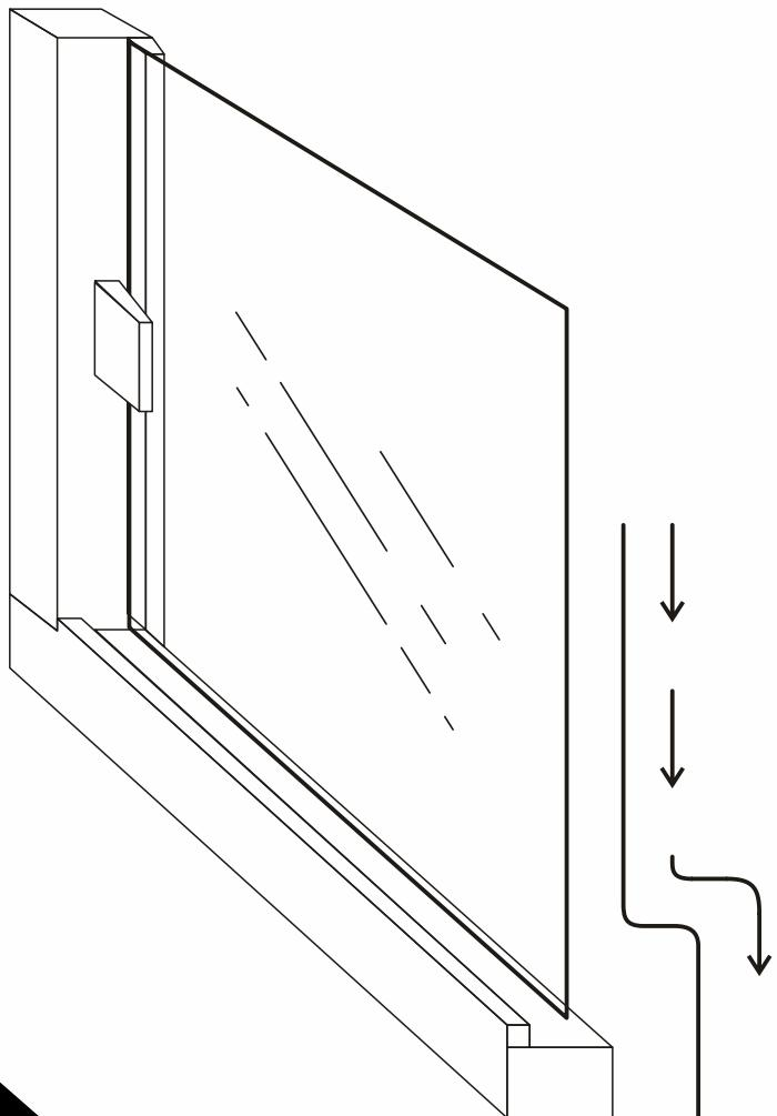
**Монтажная схема с внутренними монтажными пластинами.**
